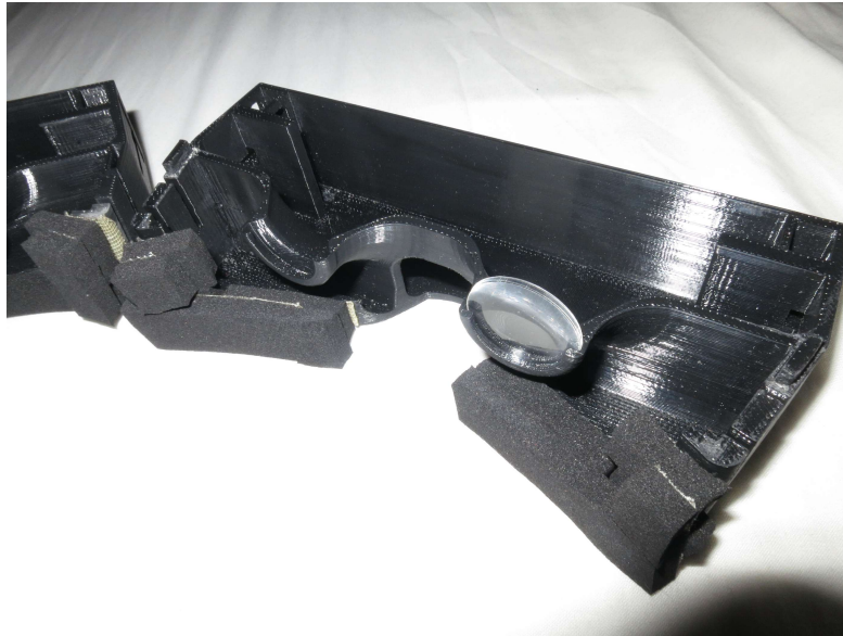
FIGURE 6.25.: Mise en place des lentilles
