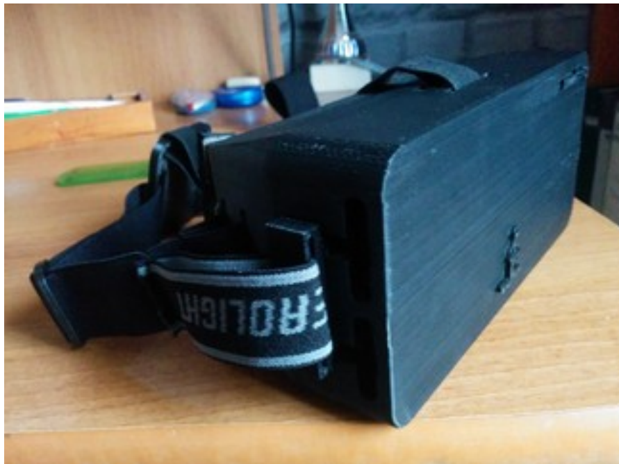
FIGURE 6.29.: Assemblage final du casque
